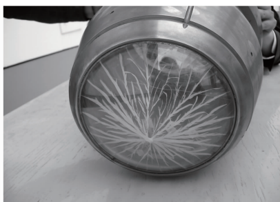
图 2 电弧风洞实验后破裂的整流罩
