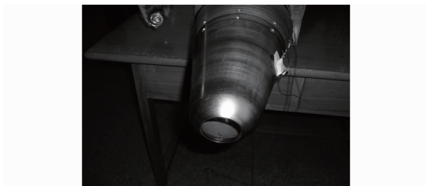
图5 切壳后完好的蓝宝石整流罩
