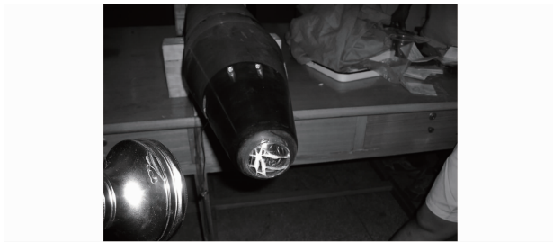
图4 切壳后损伤的尖晶石整流罩
