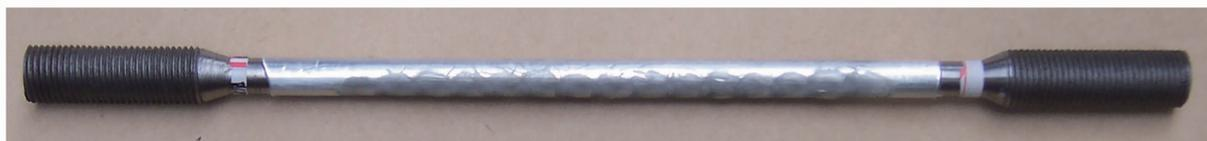
图 1 激光冲击下的 00Cr12 合金高频疲劳试样
