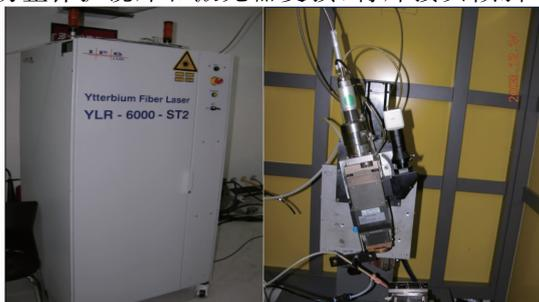
图 1 光纤激光焊接设备
