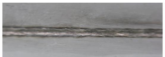
图 7 同轴保护方式对焊缝表面成形的影响
