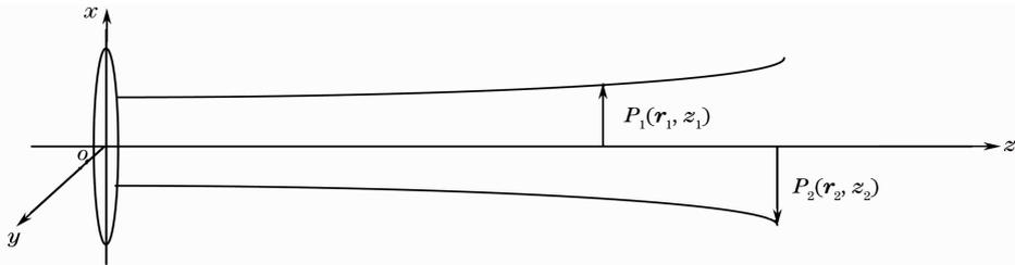
图 1 随机电磁光束通过透镜传输示意图
