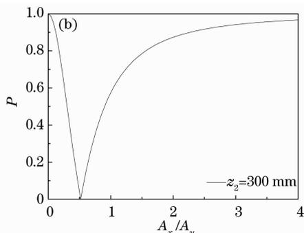
图 2 随机电磁光束系数比  $A_x/A_y$  对 LDCP 的影响
