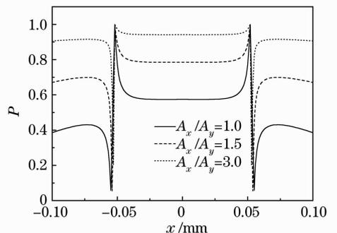
图 6 电磁光束系数比  $A_x/A_y$  对几何焦面上 TDPC 的影响
