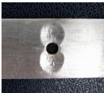
图 9 激光喷丸后小孔试样的表面形貌
