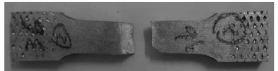
图 9 焊接接头拉伸试样的宏观断口形貌
