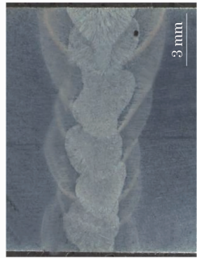
图 2 接头宏观形貌
