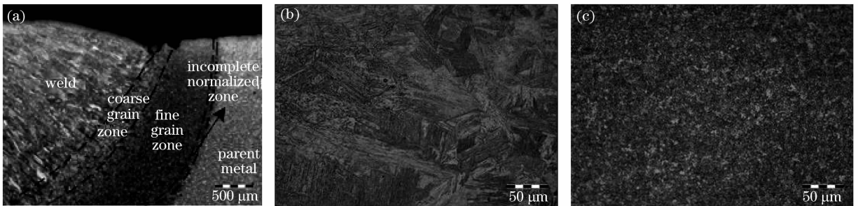
图 4 接头组织特征。(a) 接头组织分布;(b) 粗晶区;(c) 细晶区
