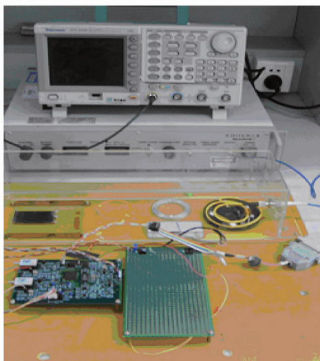
图 4 谐振式微光学陀螺实物图
