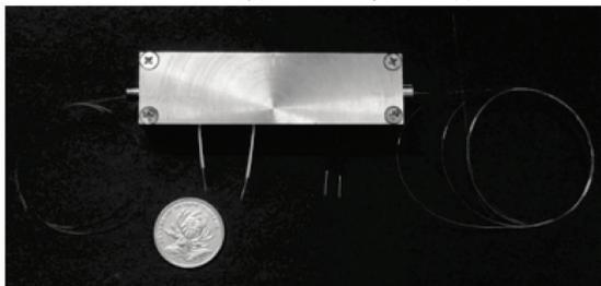
图 7 封装完成后的光功率监控器
