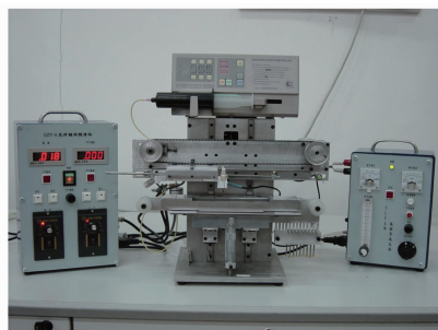
图3 电弧放电光纤研磨截面高精度抛光装置
