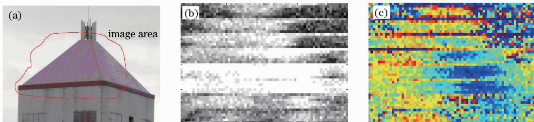
图 5 多狭缝目标重构实验结果。(a) 目标照片;(b) 强度像;(c) 距离像
