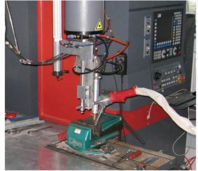
图 1 CO<sub>2</sub> 激光-电弧复合焊接试验装置
