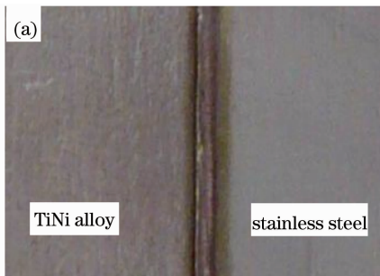
图 4 焊接接头的宏观形貌。(a) 表面形貌, (b) 截面形貌
