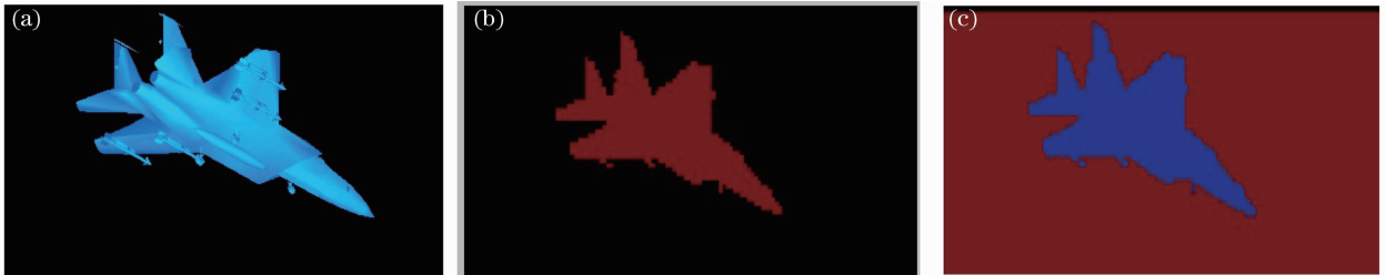
图 2 仿真目标的三维图像(a), 强度像(b)和距离像(c)
