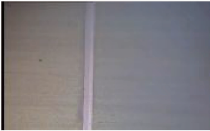
图5 刻蚀太阳能电池导电薄膜TCO
