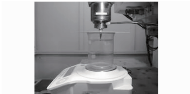
图 3 气熔比激光切割装置
