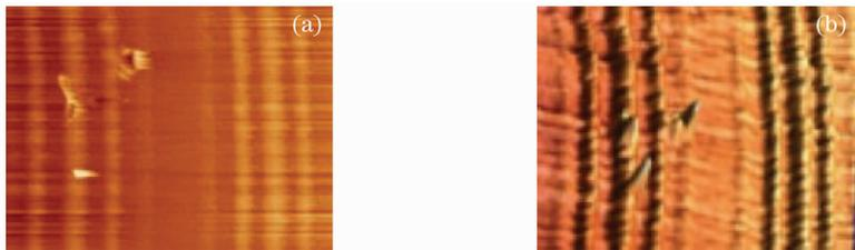
图9 偏振光直写刻得的光栅,激光光强周期性变化,间距  $10 \mu\text{m}$ :(a)二维图;(b)三维图
