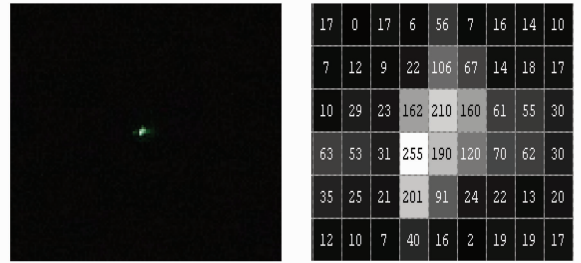
图 3 532 nm 激光对绿 CCD 的点饱和图
