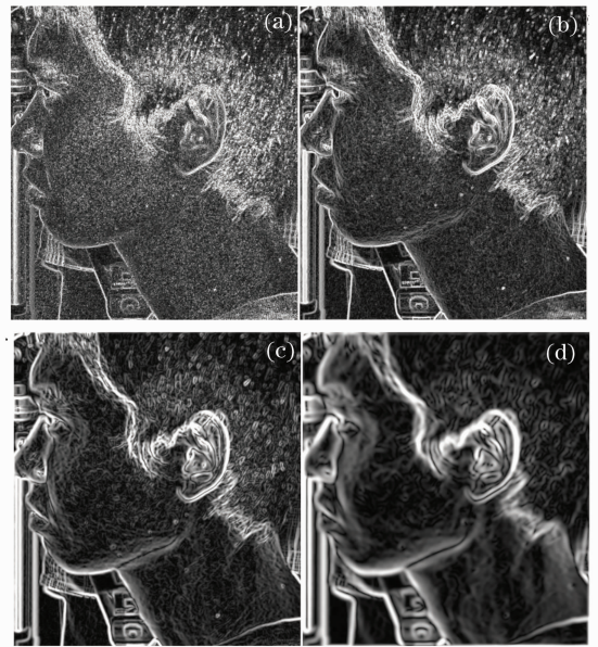
图 3 不同尺度下的小波模极大值图像。(a)原尺度;(b)1/4 尺度;(c)1/16 尺度;(d)1/64 尺度
