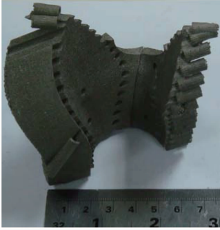
图 3 选区激光熔化技术制造的手术模板
