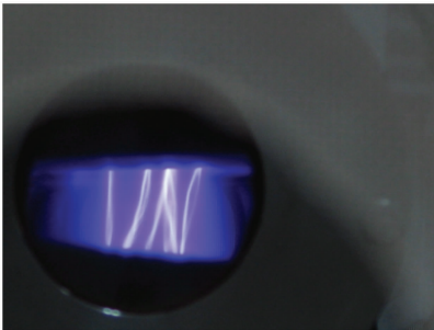
图 6 气体放电起弧照片
