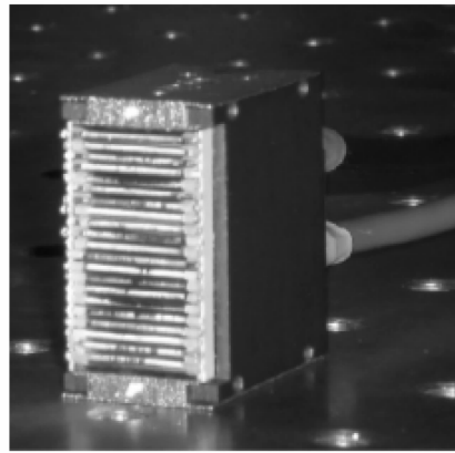
图 1 激光二极管阵列结构和照片
