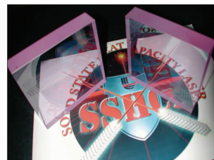
图 23 10 cm×10 cm×2 cm 的 YAG 陶瓷薄片 Fig. 23 10 cm×10 cm×2 cm thick ceramic YAG slabs
