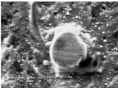
图6 原位合成陶瓷颗粒
