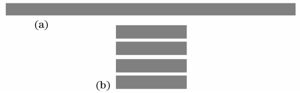
图 1 光束整形原理示意图。(a)快、慢轴准直后 LDA 的辐射;(b)光束整形后 LDA 的辐射
