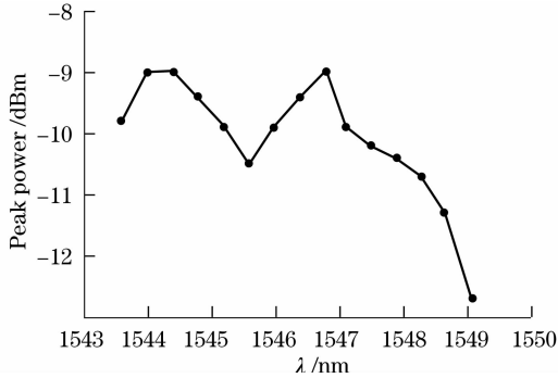
图 6 波长调谐范围内激光器的输出功率变化图
