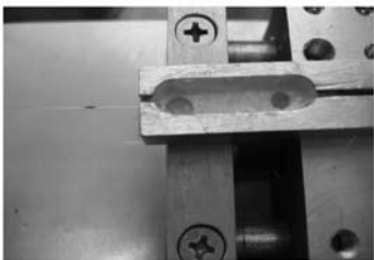
图 6 单丝拔出法研究光纤与基体之间的界面
