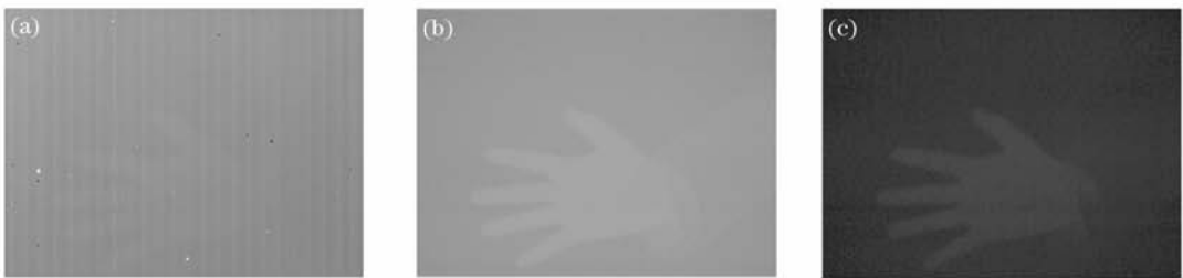
图 4 非均匀性校正算法效果比较。(a) 原始图像; (b) 两点校正; (c) 自适应两点(ATPC)校正
