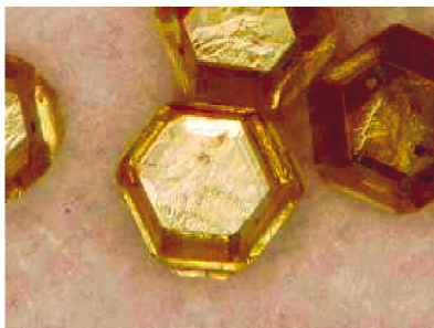
图 1 金刚石磨粒原始形貌
