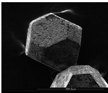
图4 腐蚀后的金刚石表面形貌
