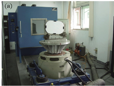
图 3 振动试验。(a) 漫射板状态;(b) 安装夹具
