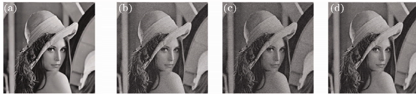
图 4 CCD 平面上的物光场不加噪声和加入不同噪声后,再现距离为 80 mm 时的再现像
