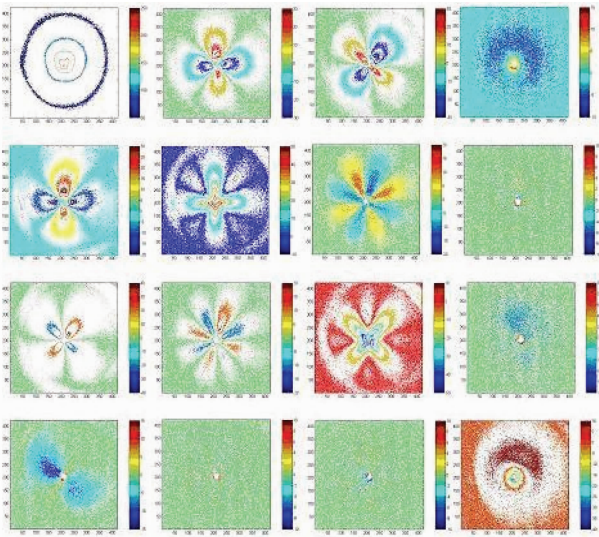
图 3 入射角 15°时体积分数为 0.08% Intralipid 悬浮液的后向散射 Mueller 矩阵
