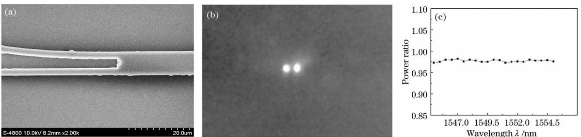
图 4 (a) MMI 结构扫描电镜图, (b) MMI 结构近场输出光斑, (c) MMI 结构两臂输出光功率比值随输入波长的变化关系
