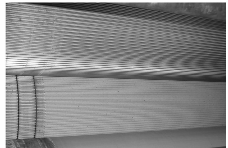
图8 激光熔覆强化的瓦楞辊在运行中
