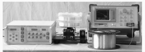
图 6 复合双环 Rayleigh 后向散射式光纤转动传感器的实验装置
