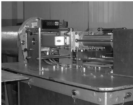
图 1 电激励 DF/HF 选线激光器核心组件示意图
