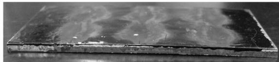
图 2 弹性预加载下激光喷丸的成形件
