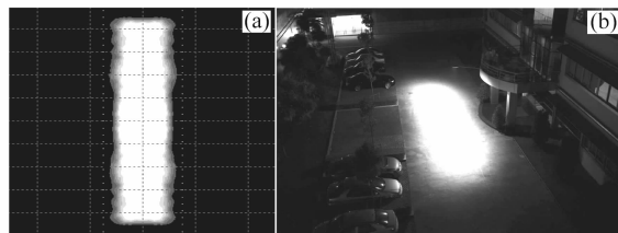
图 18 具有矩形照度的 LED 路灯。(a) 仿真结果;(b) 实际效果
