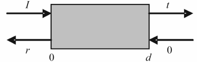
图 2 串联微环谐振器一个周期的等效系统
