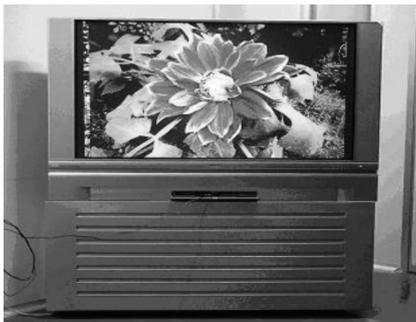
图 12 背投式激光电视样机
