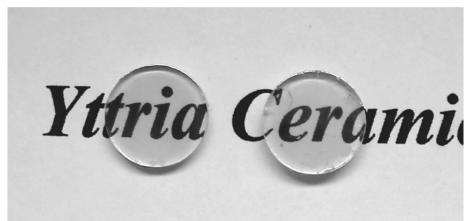
图 1 Yb:(Y 0.9 La 0.1 ) 2 O 3 多晶陶瓷样品(φ12 mm×4 mm)
