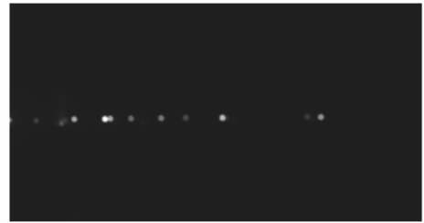
图 3 ICCD 在激光脉冲 500\text{ ns} 以后采集到的等离子体图像信号
