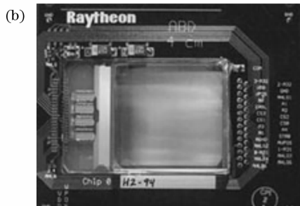
图8 液晶相控阵技术的阵列结构(a)及外观(b)
