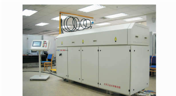
图7 大功率固体激光加工系统
