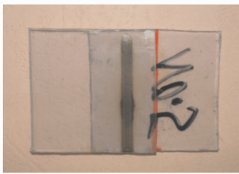
图9 焊接后的 PVC 样品 Fig. 9 Melted sample of PVC
