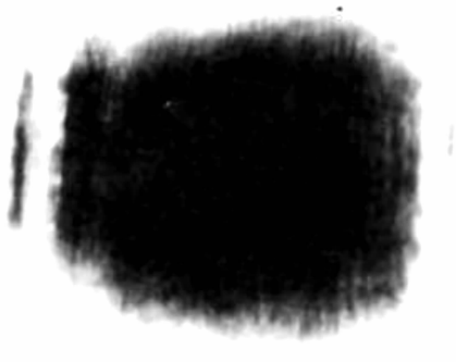
图 3 脉冲 \text{CO}_2 激光器输出的激光光斑
