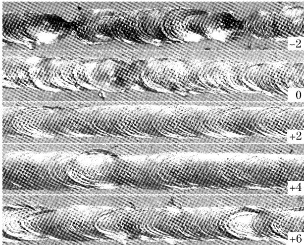
图 3 不同离焦量时的焊缝表面成型
