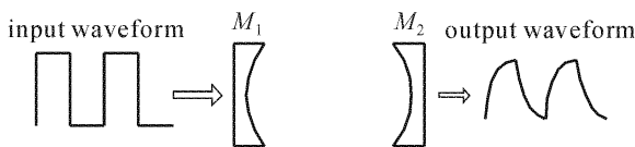
图1 直腔连续激光光腔衰荡法原理图
