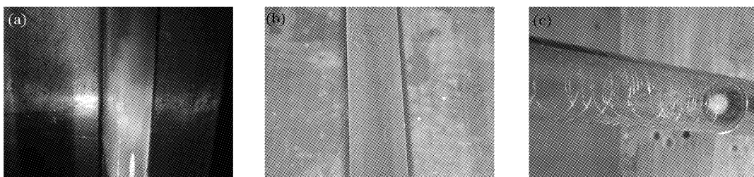
图 3 氙灯内壁块状乳白积淀物(a), 白色花纹(b)和丝状条纹(c)
