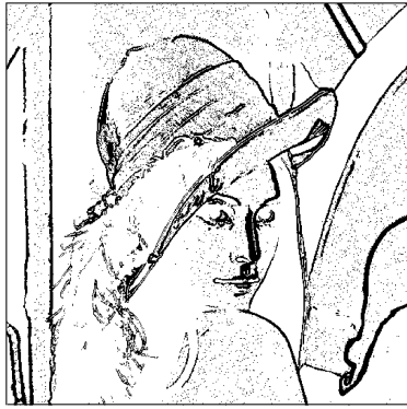
图 4 采用查涅克矩定位算法对 Lena 图像的定位结果 Fig. 4 Subpixel edge location for Lena image using Zernike moments
